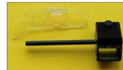
Abb. 1b: Neuzzeitliche Stereoskope; links oben Kunststoffmodell (ca. 90 x 160 mm); rechts unten Spiegel-Stereogucker (L = ca. 200 mm) zur Betrachtung von Teilbildern, die unterschiedlich groß sind.
